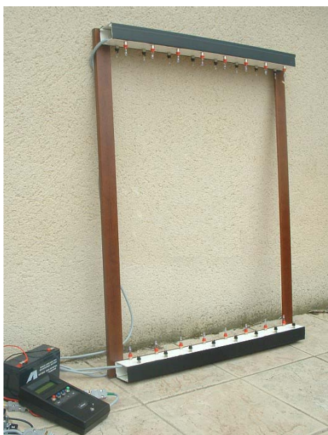
Fig 2 : rails infrarouges fixés sur un châssis qui entourera l'ouverture d'envol. Les rangées de faisceaux sont ici constituées chacune de 8 diodes et forme un rideau de 0,75m de large pour 1m de haut
