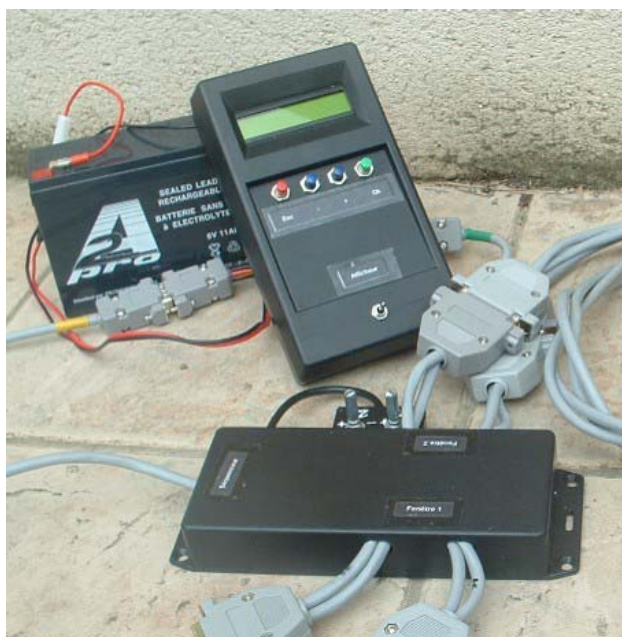
Fig 3 : le boîtier séquenceur (premier plan), le boîtier afficheur (second plan), la batterie d'alimentation (arrière plan)
